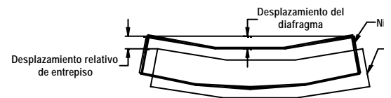
Figura 3.14 Deformaciones en un diafragma de piso rígido deformaciones llevaron a distorsiones de entrepiso bastante mayores que las consideradas en el diseño original.
